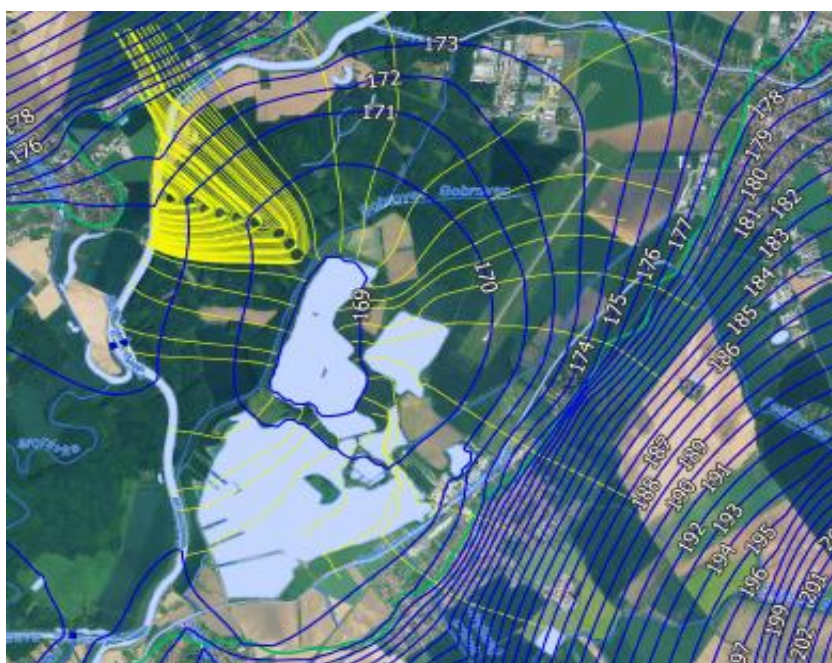
Obr. č. 8: Předpokládané hydroizohypsy kvartérní zvodně při maximálním povoleném odběru 300 l/s (žluté čáry naznačují trajektorie proudu podzemní vody)
