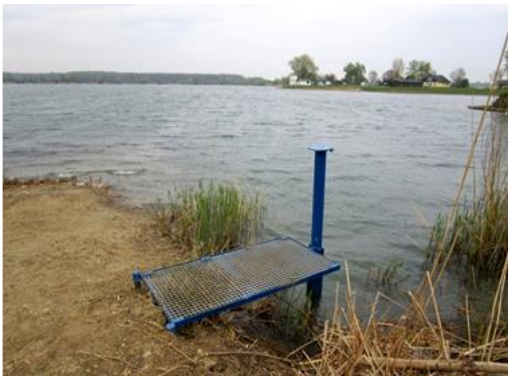
Obr.č.12 Příklad instalace dataloggeru na Vodárenském jezeře
