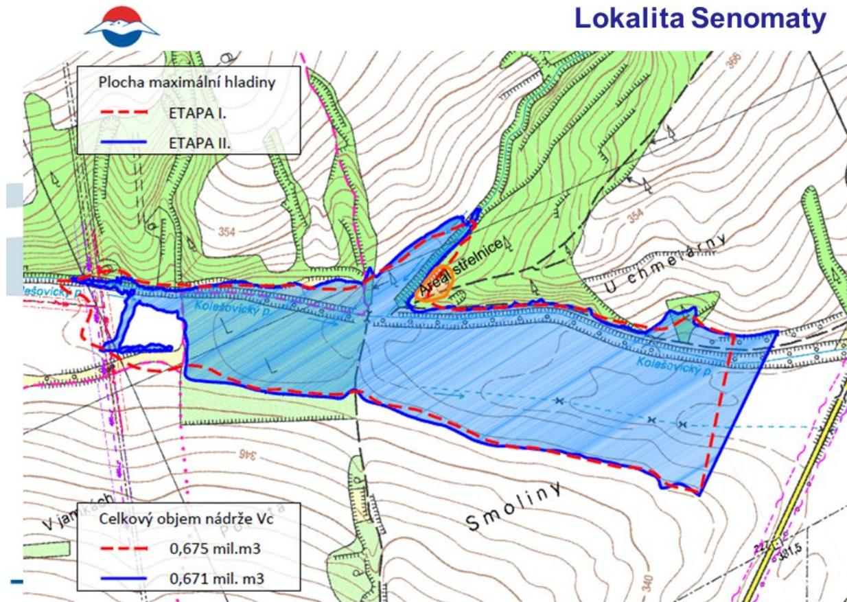
Obrázek 4: Vizualizace MVN Senomaty na Kolešovickém potoce: sypaná zemní hráz o výšce 6,8 m, celkový objem nádrže 670 725 m<sup>3</sup>, plocha nádrže 25,6 ha, nadlepšení průtoku 21,4 l/s (zdroj: Povodí Vltavy, [www.nase-voda.cz](http://www.nase-voda.cz))
