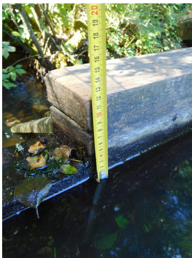
Obr. 63 Odečet hladiny v rybníku Špaček
