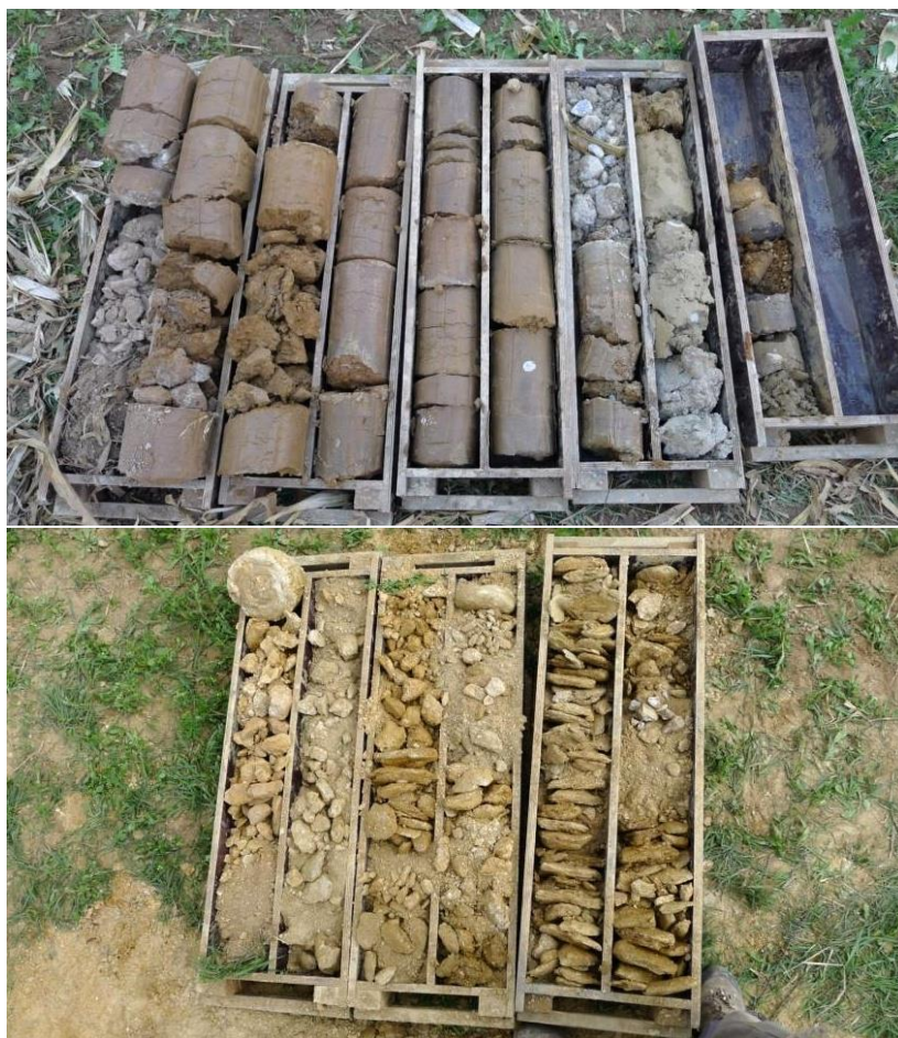
Obr. 18 Složení geologického profilu (nahore – levý svah údolí (V12), dole – pravý svah údolí (V17)).
