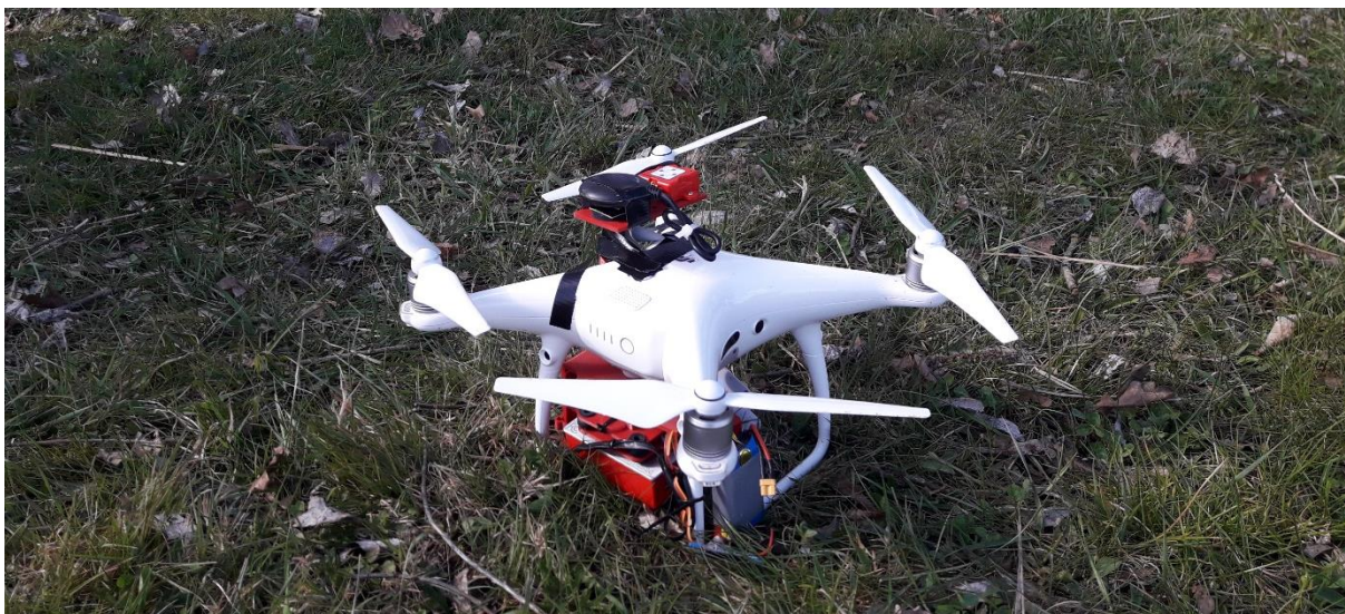
Obr. 94 Multispektrální kamera MicaSense RedEdge-M instalovaná na nosiči Phantom 4 Pro.
