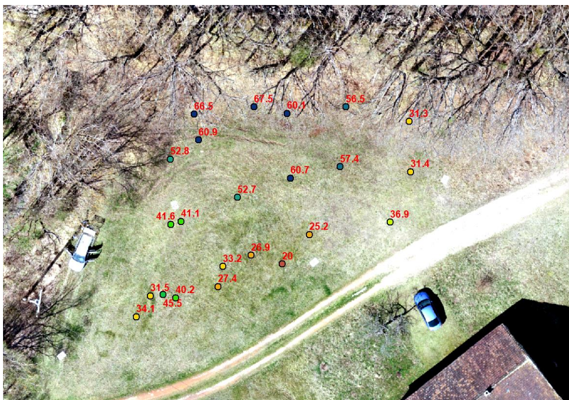
Obr. 97 Body kontaktního měření vlhkostí a jejich průměrné hodnoty v podhráží rybníka Starý u Krče.
