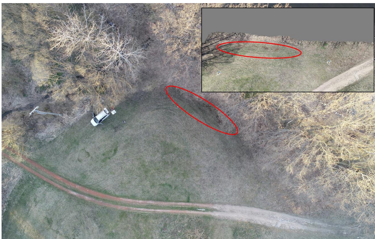
Obr. 95 Prostor podhráží rybníka Starý u Krče s vyznačením převlhčených míst.
