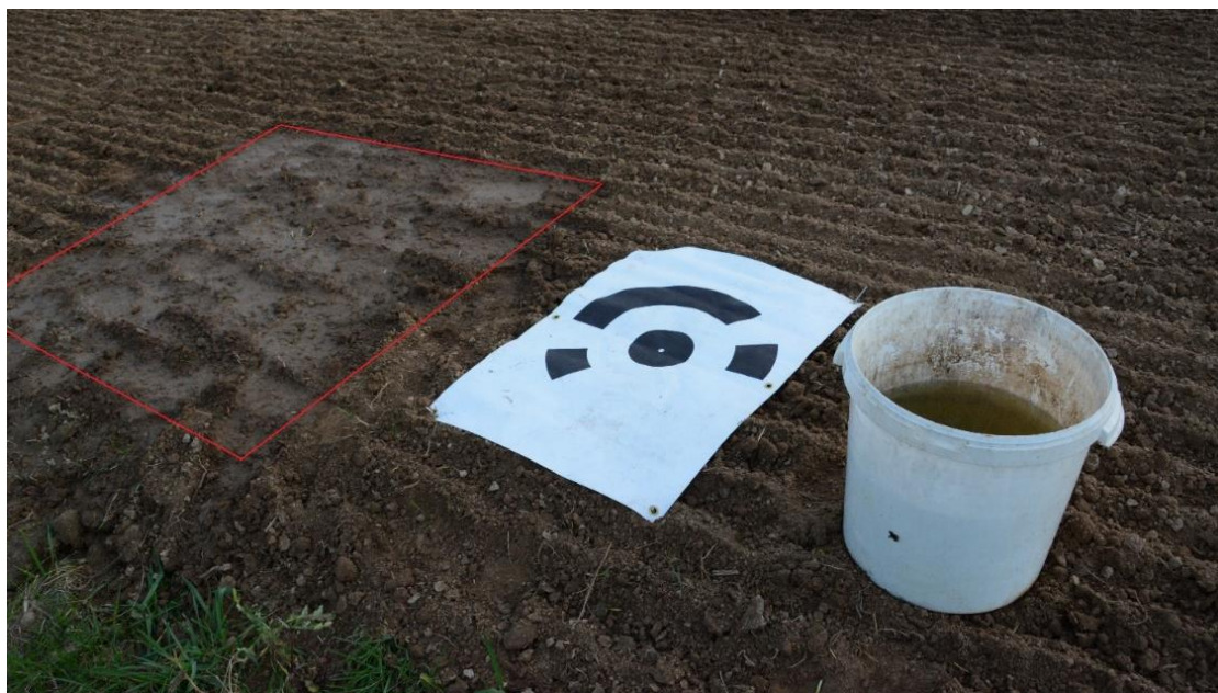
Obr. 108 Uměle zavlažená plocha 1x1 m v těsné blízkosti vřícovacího bodu a kalibrační nádoba naplněná vodou s trvale měřenou teplotou.
