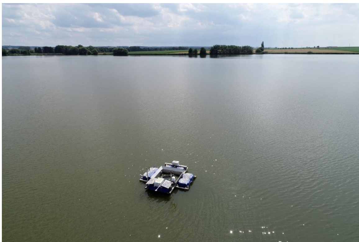
Obr. 30 Plovoucí výparoměr instalovaný na hladině rybníka Vavřinec.
